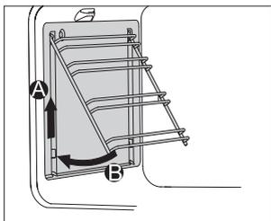
**2** Cuelgue las piezas de inserción con las guías utilizando los orificios para tal fin y tire hacia arriba.
