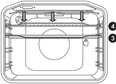
Cuando prepare alimentos utilizando el grill completo, se accionarán el calentador superior y el calentador del grill situados en la bóveda del horno.
