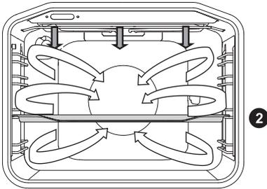
En este modo de funcionamiento, el calentador del grill y el ventilador se activan simultáneamente. Adecuado para hornear carnes, pescado y verdura.
