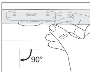
Si desea volver a conectar o activar el bloqueo de la puerta, abrir la puerta del horno y tirar de la palanca hacia usted con el índice derecho.
