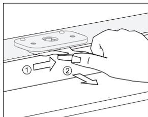
Ábrala empujándola con el pulgar ligeramente hacia la derecha y simultáneamente tirando de la puerta hacia afuera.
