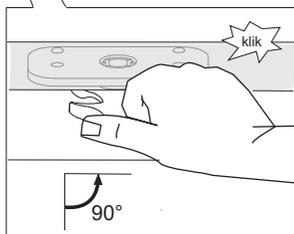
Deslice el bloqueo con el pulgar hacia la derecha en 90° hasta no sentir un clic. El bloqueo de la puerta está desconectado o desactivado.
