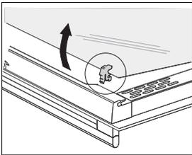
**1** Levante ligeramente los soportes situados a la derecha y la izquierda de la puerta (marca 1 en el soporte) y retírelos de la hoja de cristal (marca 2 en el soporte).
