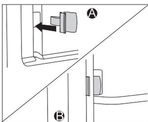
Al instalar las guías extensibles con las piezas de inserción catalíticas, introduzca un extremo de los cierres de presión suministrados en las aberturas situadas en la parte inferior del horno y el otro extremo en los cierres de presión de las guías. La finalidad de los cierres de presión es sujetar las guías en su posición con mayor firmeza.
