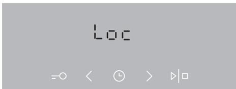
**3** Después de un cierto período de tiempo, el horno la puerta se bloqueará automáticamente para su seguridad. En la unidad de visualización aparecerá "Loc" (durante 3 segundos)".
