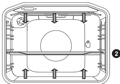
Los calentadores situados en la bóveda y la solera del horno irradian calor de forma uniforme en el interior del horno.
