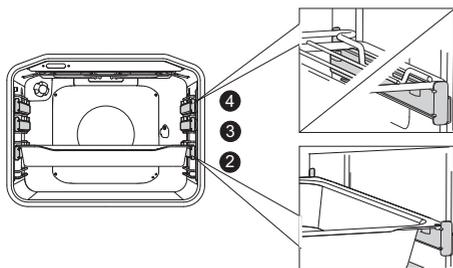
Con guías extensibles telescópicas, primero extraiga las guías de un nivel y coloque la parrilla o la bandeja de horneado sobre ellas. A continuación, empujelas con la mano hasta el final de su recorrido.
