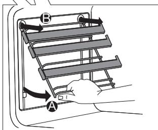
**A** Sujete las guías por su parte inferior y tire de ellas hacia el centro del interior del horno.
