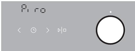
**2** Girar el BOTÓN DE AJUSTE DE TEMPERATURA todo el recorrido hasta el signo "P". Parpadeará "Pyro" en la unidad de visualización, junto con la indicación de duración de la limpieza pirolítica.
