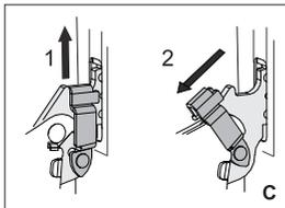
**C** Con el cierre suave levante levemente los pestillos de la puerta y tire de ellos hacia usted.
