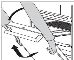
**3** Cierre suavemente la puerta hasta que los pestillos se encuentren alineados con las ranuras. Levante ligeramente la puerta y extráigala de las dos ranuras de la bisagra del aparato.
