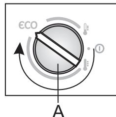
إذا كانت درجة حرارة الغرفة التي تم تثبيت الجهاز بها أقل من 16 درجة مئوية، ننصح بضبط مفتاح درجة حرارة إلى ⚡ A.
