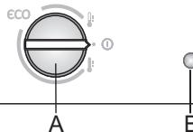
A مقبض ضبط درجة الحرارة وتشغيل / إيقاف تشغيل الجهاز on/off
