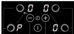
Drücken Sie die entsprechende Sensortaste (C), um die Kochzone auszuwählen. Betätigen Sie die "–" oder "+" Sensortaste (E), um die Kochstufe 9 zu wählen und drücken Sie danach sofort die Sensortaste "+". Auf der Kochstufenanzeige erscheint das Symbol "P".
