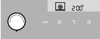
Wählen Sie die Betriebsart aus. Auf dem Display wird das ausgewählte Symbol angezeigt und die VOREINGESTELLTE TEMPERATUR blinkt.
