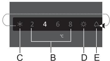
Les chiffres 2, 4, 6 et 8 indiquent la température en degrés Celsius (°C) dans le compartiment réfrigérateur.
