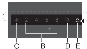
Si la température est trop élevée à l'intérieur de l'appareil, un signal sonore intermittent retentit et l'icône **E** clignote.
