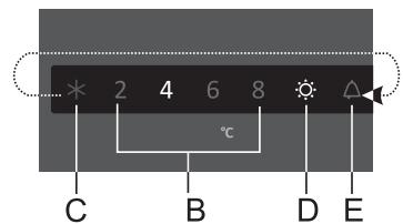
• Pour activer l'Éclairage **VitaLight**, appuyez plusieurs fois sur la touche **A** jusqu'à ce que l'icône **D** commence à clignoter. Au bout de trois seconde, la fonction est activée et l'icône **D** reste allumée. Au même moment, le réglage le plus récent de la température s'allume aussi. Lorsque l'éclairage VitaLight est actif, l'éclairage LED du bac à légumes est allumé.
