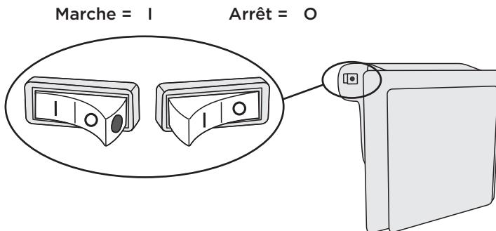
Lorsque l'ioniseur est en marche, un point rouge est visible sur l'interrupteur.
