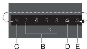
• Pour activer l'Éclairage **VitaLight**, appuyez plusieurs fois sur la touche **A** jusqu'à ce que l'icône **D** commence à clignoter. Au bout de trois seconde, la fonction est activée et l'icône **D** reste allumée. Au même moment, le réglage le plus récent de la température s'allume aussi. Lorsque l'éclairage **VitaLight** est actif, l'éclairage LED du bac à légumes est allumé.
