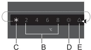
Pour activer la fonction Super Réfrigération, appuyez plusieurs fois sur la touche **A** jusqu'à ce que l'icône **C** s'allume.
