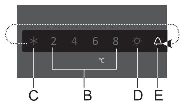
Si la température est trop élevée à l'intérieur de l'appareil, un signal sonore intermittent retentit et l'icône **E** clignote.
