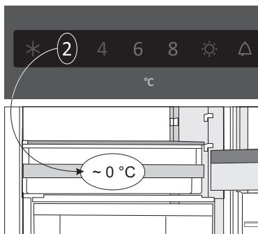
Pour obtenir une température voisine de 0°C dans ce tiroir, nous vous recommandons de régler le compartiment réfrigérateur à 4°C ou plus bas. Comme la température du tiroir peu descendre au-dessous de 0°C, il faudra ranger les aliments sensibles au gel dans la partie plus haute du réfrigérateur.
