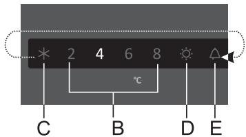
Les chiffres 2, 4, 6 et 8 indiquent la température en degrés Celsius (°C) dans le réfrigérateur.
