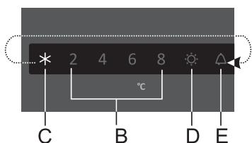
Et aktiveerida intensiivse külmutamise (kiirkülmutamise) funktsioon, vajutage järjest nupule **A** kuni süttib sümbol **C**.
