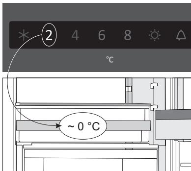
Et **ZeroZone** sahtlis oleks temperatuur umbes  $0^{\circ}\text{C}$ , soovitame külmkambri temperatuuri reguleerida alla  $4^{\circ}\text{C}$ .
