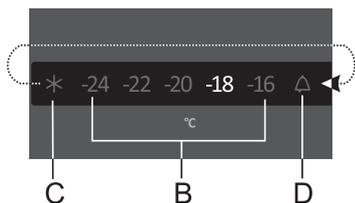
Numerot -24, -22, -20, -18 ja -16 ilmaisevat laitteen lämpötilan Celsiusasteina (°C).
