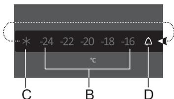
Jos lämpötila laitteen sisällä on liian korkea, kuuluu hälytysääni (katkonainen ääni) ja symboli **D** vilkkuu.
