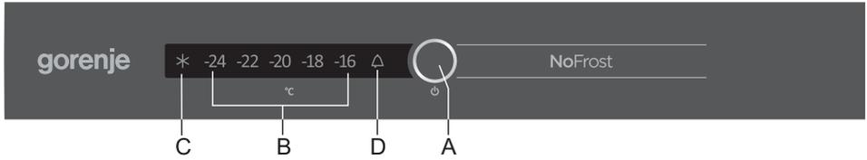
**A** Laite päälle / pois päältä, lämpötila-asetukset ja lisätoimintopainike
