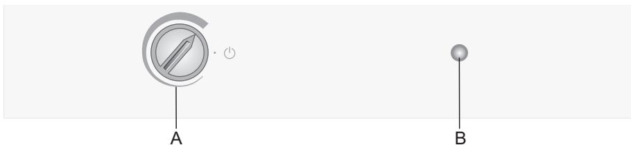
A زر ضبط درجة الحرارة وتشغيل / إيقاف الجهاز on/off
