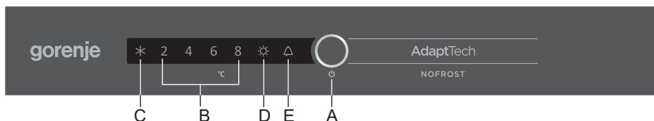
A مفتاح ضبط درجة حرارة الجهاز on/off، ووظائف اضافية
