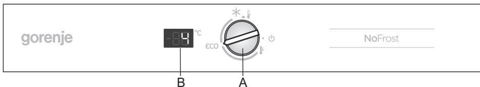
**A Dugme za uključenje i isključenje aparata, odnosno za podešavanje temperature u aparatu;** tim dugmetom upravljate i funkcijom ECO kao i intenzivnim hlađenjem/zamrzavanjem.
