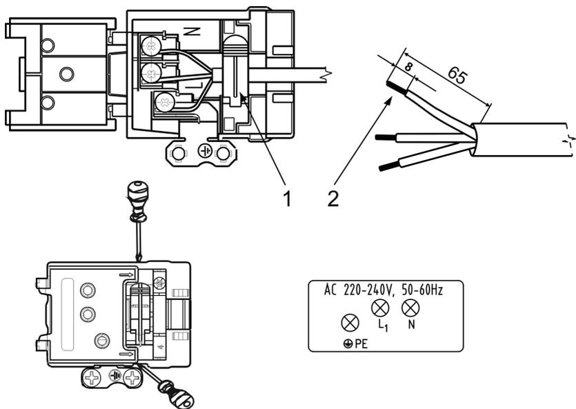
1. 防止电线断裂的环扣
