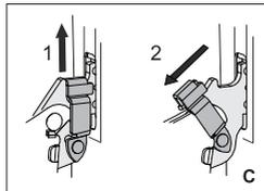
**C** Si l'appareil est équipé du système de fermeture amortie, soulevez légèrement les petits leviers et tirez-les vers vous.
