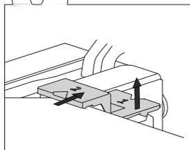
**1** Soulevez légèrement les supports situés sur les côtés droit et gauche de la porte (repère 1 sur le support) et retirez-les de la vitre (repère 2 sur le support).
