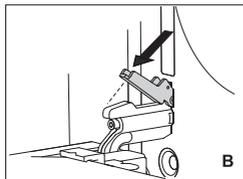
**B** Fermeture amortie : faites pivoter les butées à 90°.
