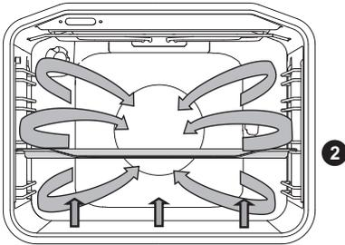
La résistance de sole, la résistance circulaire et le ventilateur fonctionnent en même temps. Ce mode convient à la cuisson des pizzas, tartes aux pommes et gâteaux aux fruits.
