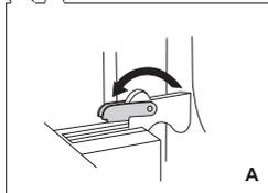
**2<sup>A</sup>** Fermeture conventionnelle: faites pivoter les butées vers l'avant, jusqu'au bout.
