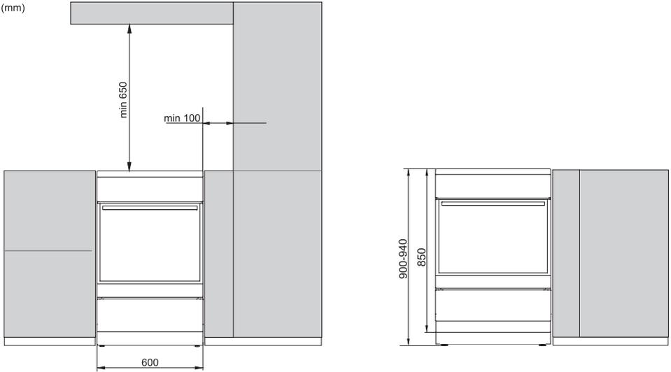
Les murs et le mobilier situés à proximité de l'appareil (plancher, mur derrière la cuisinière, cloisons latérales) doivent résister à une température de 90°C au moins.
