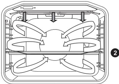
Le gril et le ventilateur fonctionnent simultanément. Ce mode convient à la cuisson de la viande, du poisson et des légumes.
