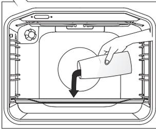
**2** Versez 0,6 l d'eau dans la lèche-frite et placez-la sur le gradin du bas.
