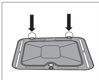
**3** Insérez-la dans les trous à gauche et à droite, à l'arrière du four, et fixez-la à l'avant pour l'empêcher de se déplacer lors de la prochaine utilisation de l'appareil.
