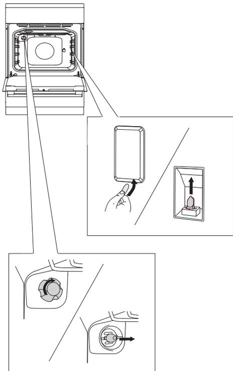
Avec un tournevis plat, soulevez le couvercle de l'ampoule et enlevez-le.
