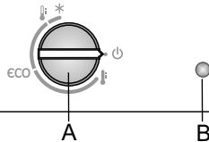
**A Gumb za vklop in izklop aparata oziroma nastavitev temperature v aparatu;**
