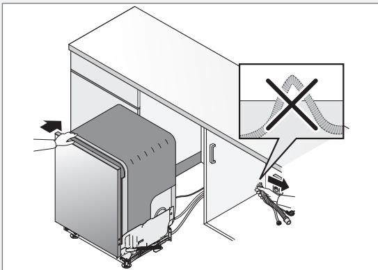
7 對著機腳做最後調整 (洗碗機傾斜不得超過 5 公釐)，然後鎖緊前腳的固定螺帽。
