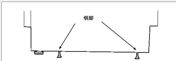
3 在调整好钢脚之后，再拧紧两个橡胶脚，使其牢牢抵住地板。橡胶脚可防止洗碗机倾倒。
