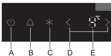
**Uključenje aparata:** Aparat uključite kratkim pritiskom tipke **A**.
