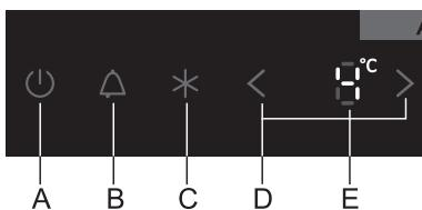
U slučaju previsoke temperature u aparatu, uključi se zvučni signal (**isprekidan zvuk**) i trepće tipka **B**.
