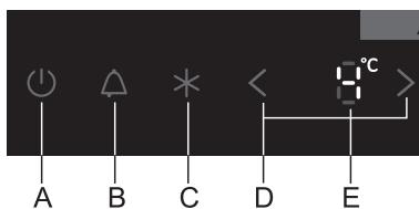
Ovu funkciju koristite kad želite sprečiti nehotično upravljanje aparatom. Mogućnost uključite 3 sekunde dugim pritiskom na tipku **B**. Na indikatoru **E** prikaže se slovo **LL**. Time ste zaključali sve tipke izuzev tipke **B**. Bezbednosnu zaštitnu blokadu isključite ponovnim pritiskom tipke **B**, dugim 3 sekunde.
