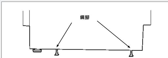
3 適當調整鋼腳之後，請鎖緊兩個橡膠腳墊使其牢貼地板，橡膠腳墊可防止洗碗機翻覆。
