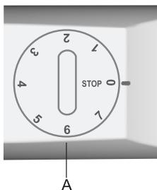
Les réglages sur les chiffres élevés (vers la position 7) correspondent aux températures les plus basses (plus froides). Dans ce cas, la température du réfrigérateur peut descendre au-dessous de 0°C. Ne réglez le thermostat sur les valeurs élevées que s'il est souhaitable et recommandé d'obtenir une réfrigération intense ou si la température ambiante est inférieure à 16°C. Quand la température ambiante est normale, nous vous conseillons de régler le thermostat sur une valeur moyenne.
