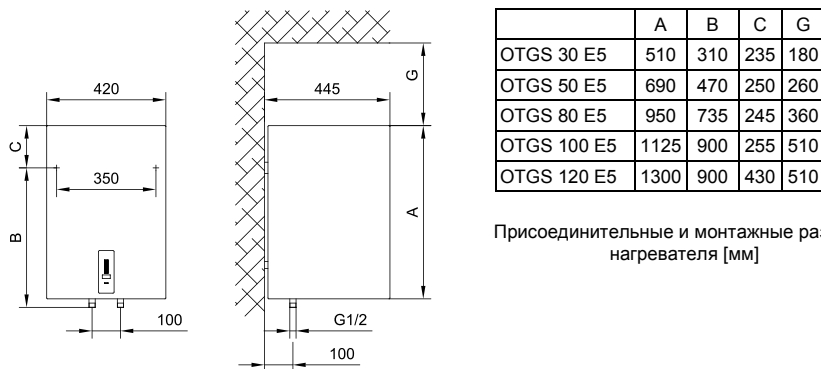
Рис. 1: Монтаж на стену в вертикальном положении
