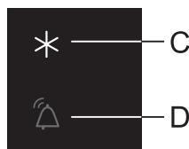
Чтобы включить функцию «Интенсивное охлаждение», нажмите на кнопку **A**, пока не загорится индикатор **C**.
