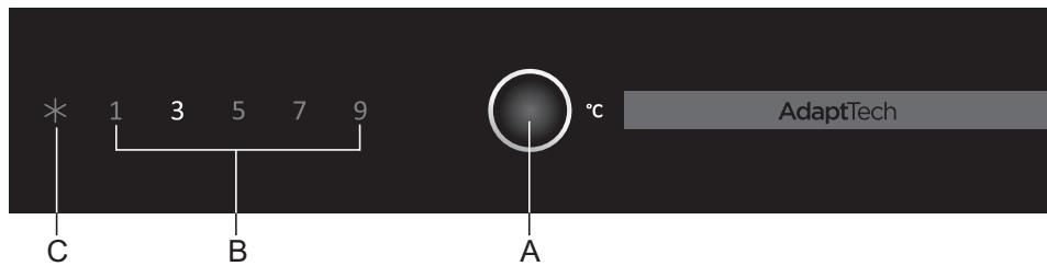
А Кнопка установки температуры и включения «Интенсивного охлаждения»
