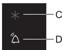
При превышении допустимой температуры в холодильнике включается прерывистый звуковой сигнал и мигает индикатор **D**.
