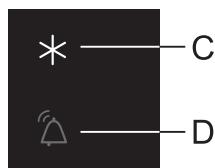
Pour activer la fonction Réfrigération rapide, appuyez sur la touche **A** jusqu'à ce que l'icône **C** s'allume.
