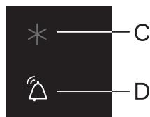
Lorsque la température est trop haute dans le réfrigérateur, un signal sonore intermittent retentit et l'icône **D** clignote.
