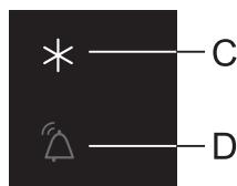
Чтобы включить функцию «Быстрое замораживание», нажмите на кнопку **A**, пока не загорится индикатор **C**.
