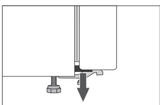
An den Ecken der Gerätetür sind Distanzhalter angebracht, die Sie entfernen und durch die mitgelieferten Stöpsel (nur bei einigen Modellen) ersetzen.
