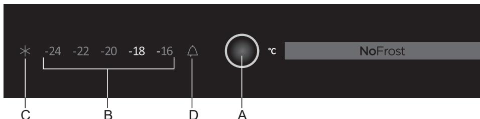
A Taste zur Temperatureinstellung und zum Aktivieren der Funktion Intensivgefrieren
