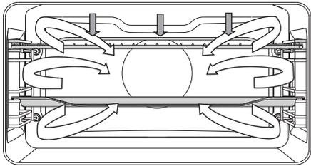
Le grill infrarouge et le ventilateur fonctionnent simultanément. Ce mode convient à la cuisson de la viande, du poisson et des légumes.
