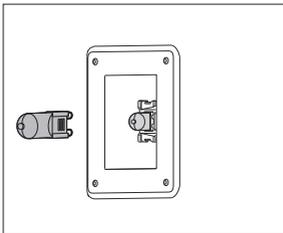
**2** Retirez la lampe halogène et remplacez-la par une neuve.
