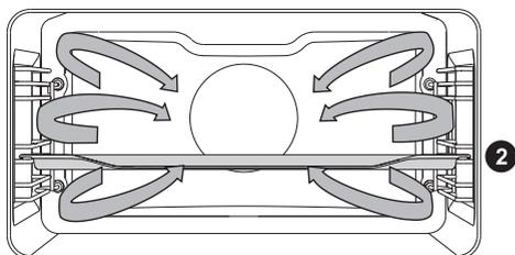
La résistance circulaire et le ventilateur fonctionnent simultanément. Le ventilateur situé au fond du four fait circuler autour du rôti ou du gâteau la chaleur produite par la résistance circulaire.
