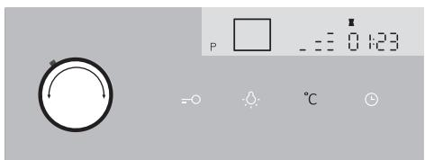
**2** Виберіть ступінь очищення, для цього натисніть на сенсор ТЕМПЕРАТУРИ і за допомогою ПЕРЕМІКАЧА ЗМІНИ/ВИБОРУ НАЛАШТУВАНЬ виберіть ступінь очищення.
