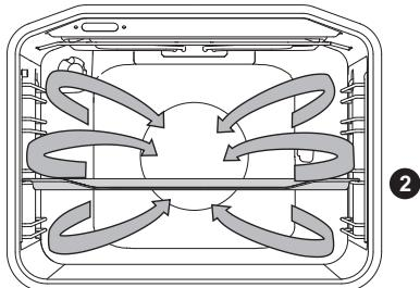
Одночасно працюють нагрівальний елемент навколо вентилятора і вентилятор. Вентилятор забезпечує циркуляцію гарячого повітря навколо м'яса або випічки.
