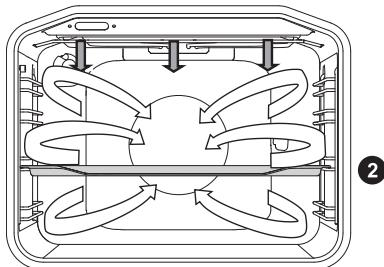
Одночасно працюють верхній нагрівальний елемент, інфраангравч і вентилятор. Призначений для приготування м'ясо, риби, овочів.
