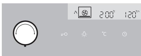
**3** Поверніть ПЕРЕМІКАЧ РЕЖИМУ НАГРІВУ в положення «Нагрівання знизу + вентиляційний нагрів». На дисплей загоряться символи режиму нагріву і підключенного зонда, попередньо встановлена температура духовки і температура зонда. Натисніть на сенсор СТАРТ / СТОП.
