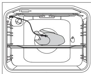
**2** Штекер зонда вставте в гніздо і встреміть зонд в шматок м'яса. Якщо були встановлені функції, що програмують час роботи приладу, вони обнуляться.
