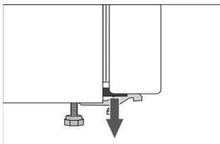
Les coins de la porte sont protégés par des entretoises. Enlevez-les et insérez à la place, dans les orifices, les caches livrés avec l'appareil (uniquement pour certains modèles).
