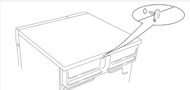
2. 使用螺絲固定的防傾斜裝置，如圖所示。
