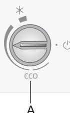
A Dugme za regulisanje temperature, za uključenje i isključenje aparata, i za aktiviranje intenzivnog zamrzavanja
