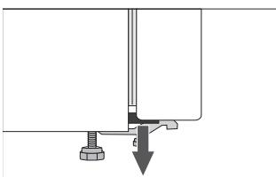
Suojakappaleet on asennettu ovien kulmiin. Irrota ne ja lataa toimitukseen sisältyvät tulpat paikoilleen (vain joissakin malleissa).
