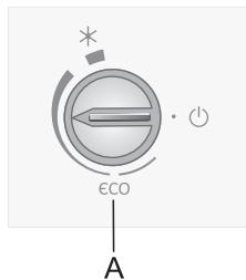
**Einschalten:** Drehen Sie den Thermostatknebel **A** im Uhrzeigersinn in Richtung **der breiten Signatur**.
