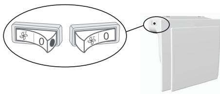
Kad su ventilator i ionizator uključeni, na prekidaču može da se vidi crvena tačka.
