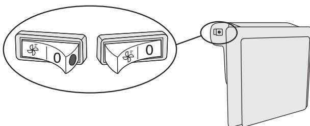
Когда вентилятор и ионизатор воздуха включены, на выключателе видна красная точка.
