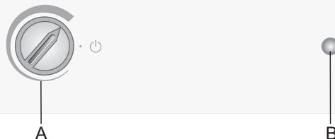
А Переключатель вкл./выкл. и установки температуры
