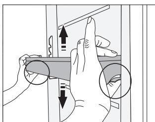
Полки можно переставлять по высоте, при этом их не требуется снимать с дверцы. Потяните фиксаторы по обе стороны полки на себя и переместите полку вверх или вниз.
