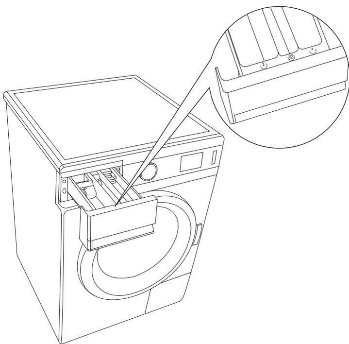
Le bac à produits lessiviels est équipé d'une cloison mobile vous permettant de verser le détergent liquide dans le compartiment du milieu (selon les modèles). Pour la lessive en poudre, tirez la cloison vers le haut, et pour la lessive liquide, poussez-la vers le bas.
