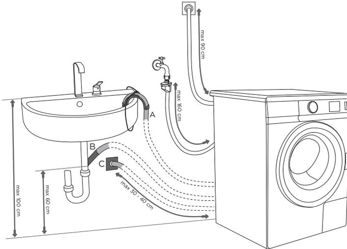
**A** Vous pouvez placer le flexible de vidange sur le rebord d'un évier, d'un lavabo, ou d'une baignoire. Fixez le tuyau à l'aide d'une ficelle que vous passerez dans l'œillet du coude pour éviter qu'il tombe par terre.
