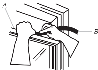
A A felső ablakszárny teteje B Tömítőszalag
