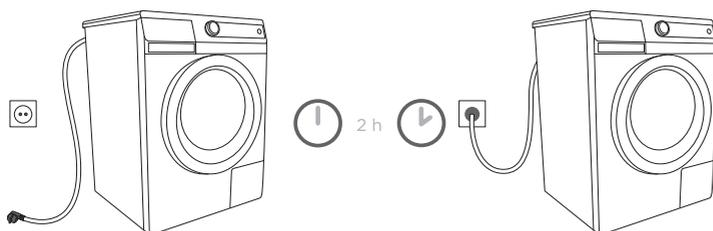
**Après avoir mis l'appareil en place pour la première fois, attendez deux heures avant de le raccorder au réseau électrique.**
