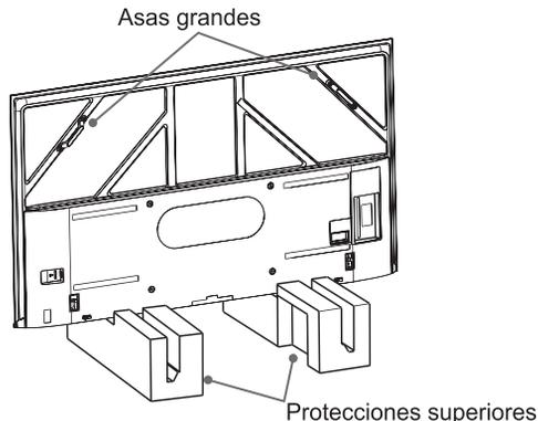
3. Una persona sostiene el TV desde el frente, la otra persona saca 4 tornillos (M5 × 16) para instalar el soporte en los siguientes pasos: saque la abrazadera del cable del soporte, fije los soportes al TV con tornillos y luego vuelva a colocar la abrazadera del cable en su lugar original. Después de la instalación, mueva el TV al lugar designado.
