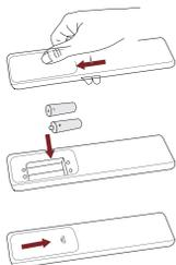
1. Deslice la cubierta trasera para abrir el compartimiento de pilas del control remoto.
