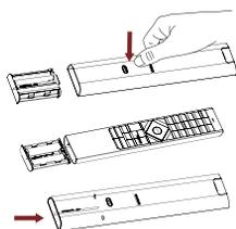
1. Premere la levetta e lo sportellino della batteria uscirà automaticamente.
