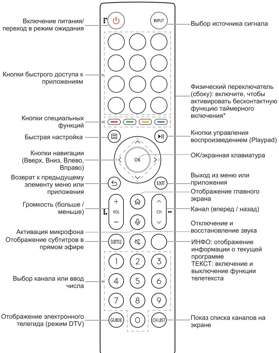
\*Если вы не используете бесконтактную функцию таймерного включения, выключите физический переключатель, чтобы продлить срок службы батареек.
