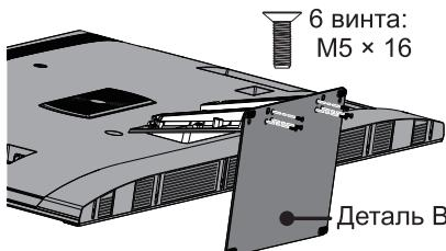
7. Затем закрепите деталь В 2 винтами (ST4 × 12).
