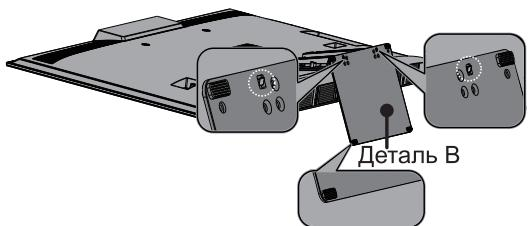
6. Затем закрепите деталь В 6 винтами (M5 × 16).
