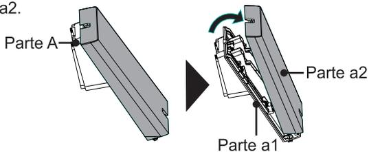
3. Installare la Parte a1 sull'involucro posteriore del televisore.
