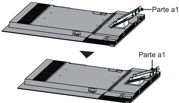
4. Assicurare la Parte a1 con 4 viti (M5 × 12) sull'involucro posteriore del televisore.
