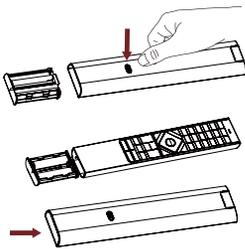
1. Pulse el interruptor y la caja de la batería aparecerá automáticamente.
