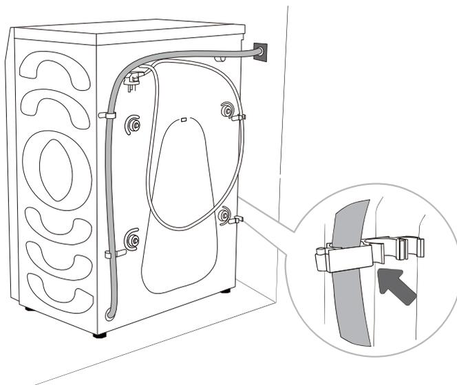
**D** Der Abflussschlauch muss am Stift auf der Rückseite des Wäschetrockners angebracht und fixiert werden, siehe Abbildung.
