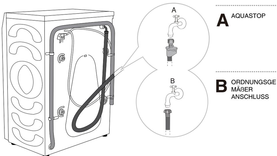
☞ Für den normalen Betrieb des Wäschetrockners sollte in der Wasserleitung (im Wassernetz) ein Druck zwischen 0,1-1MPa (1-10bar; 1-10kp/cm<sup>2</sup>; 10-100N/cm<sup>2</sup>) herrschen. Der minimale dynamische Wasserdruck kann durch Messen des Wasserdurchflusses ermittelt werden. In 15 Sekunden sollten 3 Liter Wasser aus einem vollständig geöffneten Wasserhahn fließen.
