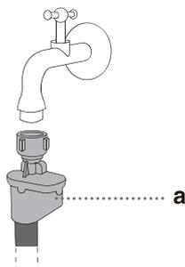
☼ Tauchen Sie den Wasserzulaufschlauch mit dem Aqua-Stop-System nicht in Wasser, da er ein elektrisches Ventil enthält.
