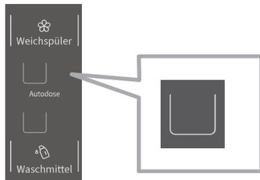
Der Enthärter ist ausgeschaltet und wird am Ende des Programms nicht dosiert. Dies ist auf dem Display wie in der Abbildung unten zu sehen. Keine LED-Anzeige.
