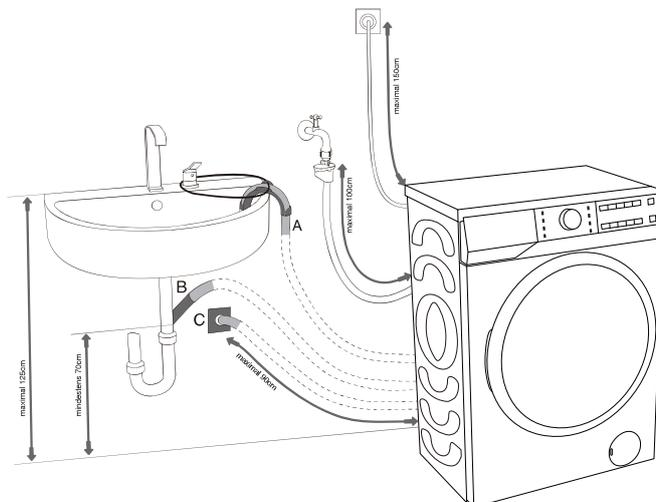
**A** Das Ende des Ablaufschlauchs kann über einem Waschbecken oder einer Badewanne platziert werden. B Fixieren Sie den Schlauch mit einer Schnur, die Sie durch die Öffnung in der Winkelhalterung führen, so dass er nicht auf den Boden rutschen kann.
