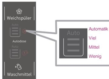
Wenn das Auto-Symbol auf EIN steht und alle 3 Zeilen auf EIN stehen, bedeutet dies, dass Sie die automatische Dosierungsfunktion gewählt haben. Der Weichspüler wird automatisch dosiert, je nachdem, wie viel Wäsche sich in der Trommel befindet.
