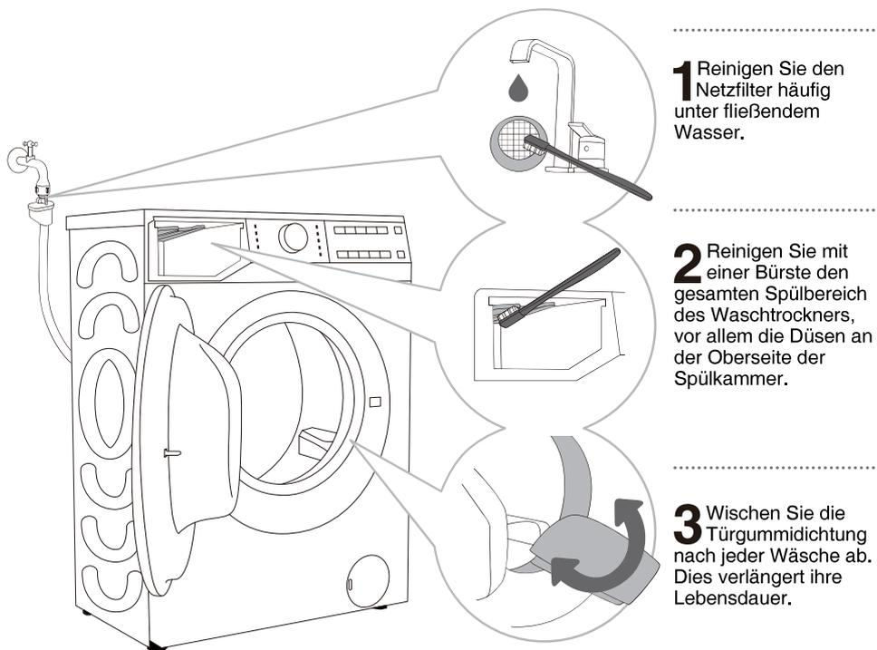
**1** Reinigen Sie den Netzfilter häufig unter fließendem Wasser.
