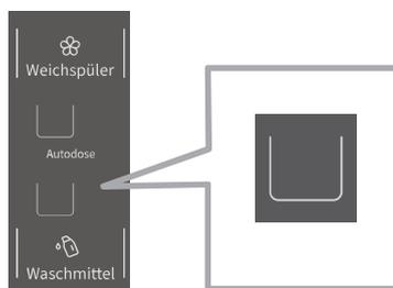
Die Waschmittelzugabe ist ausgeschaltet und wird am Ende des Programms nicht dosiert. Dies ist auf dem Display wie in der Abbildung unten zu sehen. Keine LED-Anzeige.
