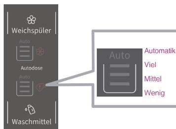
Wenn das Auto-Symbol auf EIN steht und alle 3 Zeilen auf EIN stehen, bedeutet dies, dass Sie die automatische Dosierungsfunktion gewählt haben. Das Waschmittel wird automatisch dosiert, je nachdem, wie viel Wäsche sich in der Trommel befindet.
