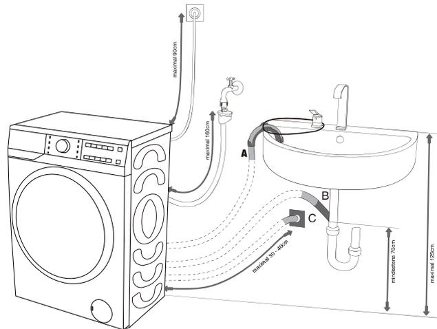
**C** Der Abflussschlauch kann auch an einen Wandabfluss mit Siphon angeschlossen werden; ein solcher Siphon sollte zu Reinigungszwecken ordnungsgemäß installiert sein.
