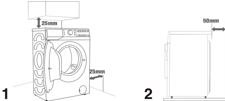
☼ Der Wäschetrockner darf nicht mit einer Wand oder angrenzenden Möbeln in Berührung kommen. Für einen optimalen Betrieb des Wäschetrockners empfehlen wir, die in der Abbildung angegebenen Abstände zu den Wänden einzuhalten. Bei Nichteinhaltung der erforderlichen Mindestabstände ist ein sicherer und ordnungsgemäßer Betrieb des Wäschetrockners nicht gewährleistet. Außerdem kann es zu einer Überhitzung kommen (Abbildungen 1 und 2).
